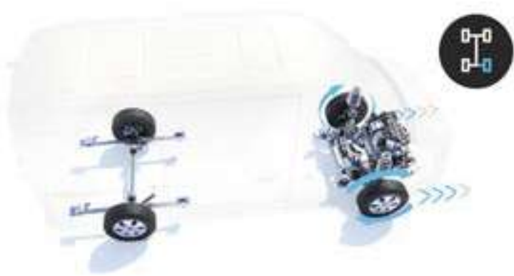
ASR El control electrónico de tracción (ASR) reduce la potencia del motor y actúa sobre los frenos cuando alguna de las llantas se resbala para evitar que gire en vacío.
