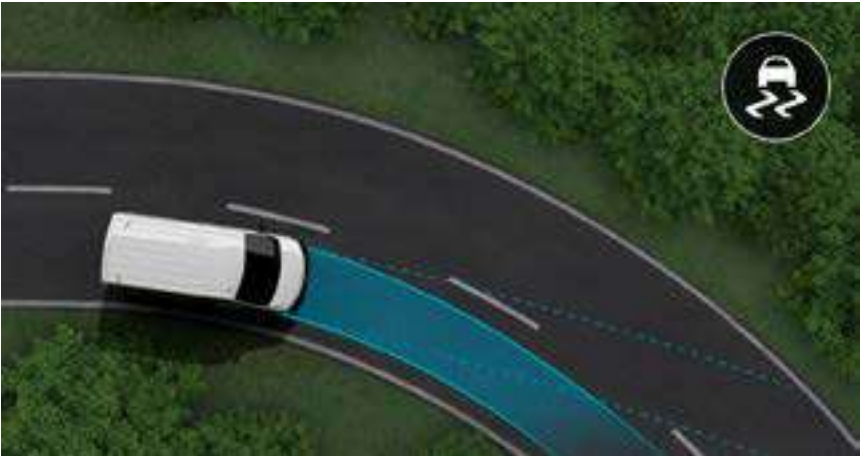
ESP El control electrónico de estabilidad (ESP) permite corregir la trayectoria del coche para evitar derrapes.
